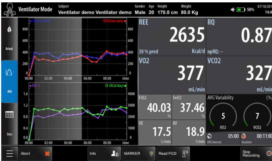
Dashboard in tempo reale di un test ventilatore. Mostra i valori metabolici e ventilatori insieme a widgets che evidenziano parametri utili al controllo di qualità e a capire quando il test può concludersi
