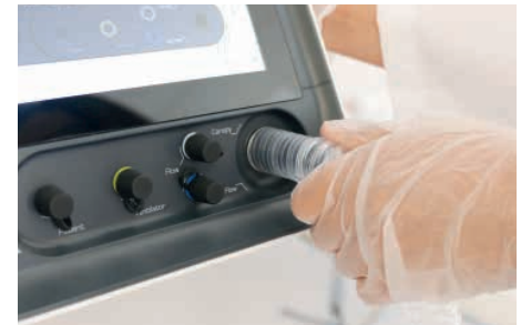
I test con il canopy sono semplici da configurare connettendo il tubo corrugato al blower
